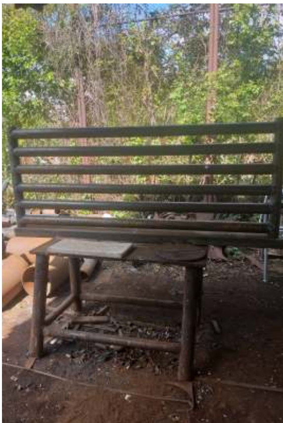
img 40, img 41 Activități - confecționat registre instalație încălzire atelier RP
