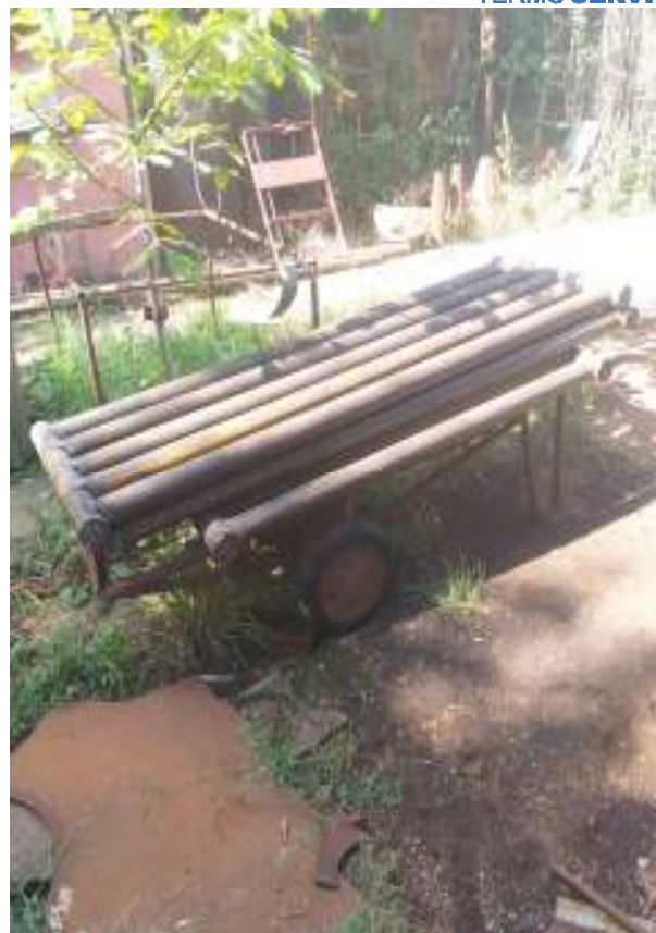
img 40, img 41 Activități - confecționat registre instalație încălzire atelier RP
